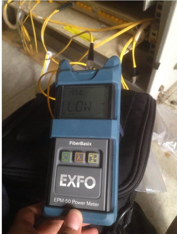
**Gambar 3.6** Pengecekan Daya Optik Menggunakan Power Meter
