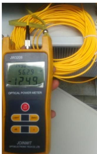
Gambar 14 - Hasil pengukuran redaman pada OPM
