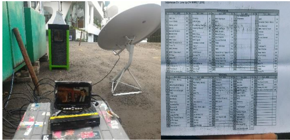
Gambar 3.20 Pengecekan Siaran Tv dengan TV tuner dan antena parabola
