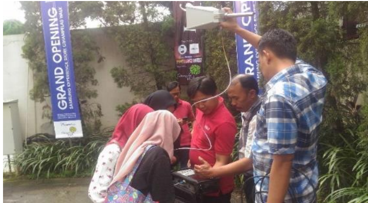
Gambar 3.17 Pengukuran Frekuensi di stasiun terganggu
