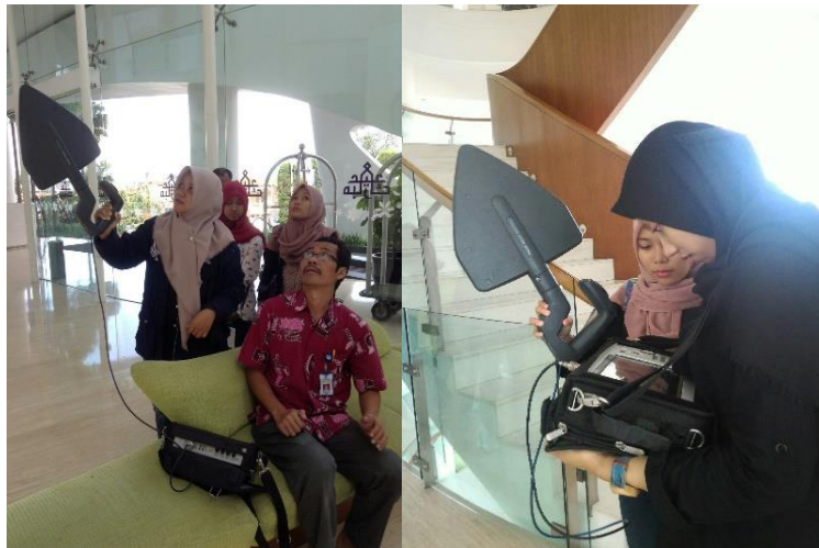
Gambar 3.18 Pencarian Sumber gangguan dengan menggunakan Antena
