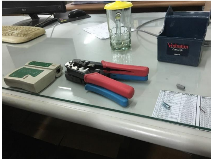
Gambar 3.10 Alat Dan Bahan Pemasangan Kabel RJ-45 Dan RJ-11
