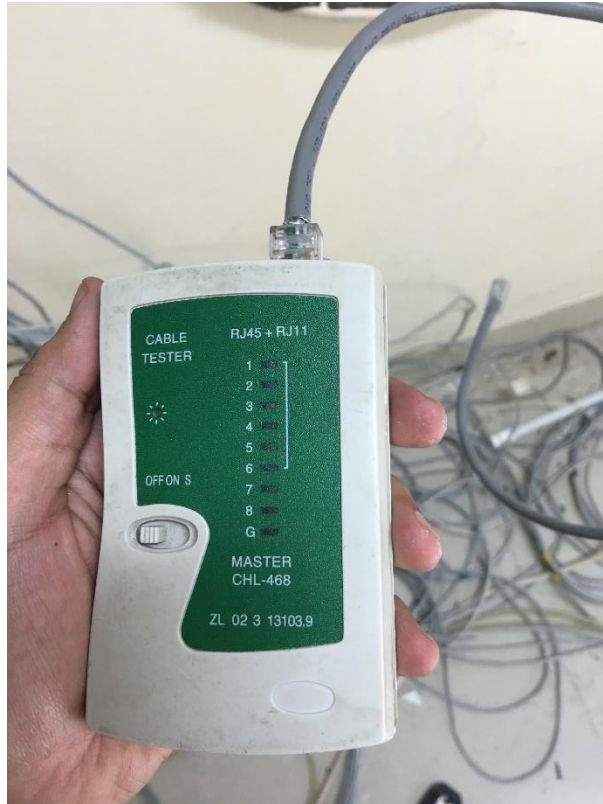
Gambar 3.12 Pengetesan Kabel RJ-45 Dengan LAN Tester
