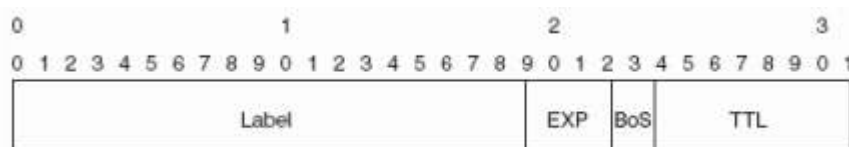
Gambar 3.2 Format Header MPLS [4]
