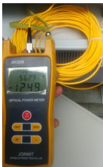
Gambar 12 - Hasil pengukuran redaman pada OPM
