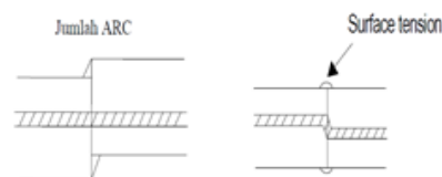
Gambar 3.2.7 Penyambungan 1 Kali ARC (Kiri) Dan Penyambungan 2 Kali ARC (Kanan)
