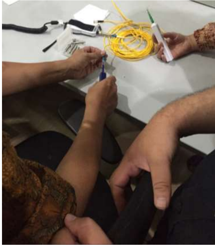
Gambar 3.4 Pembersihan probe patch cord dengan FOC
