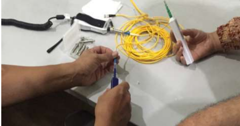
Gambar 3.10 Pembersihan Probe dengan Fiber Optic Cleaner
