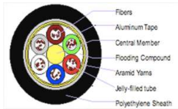
Gambar 3.4 Struktur Kabel duct
